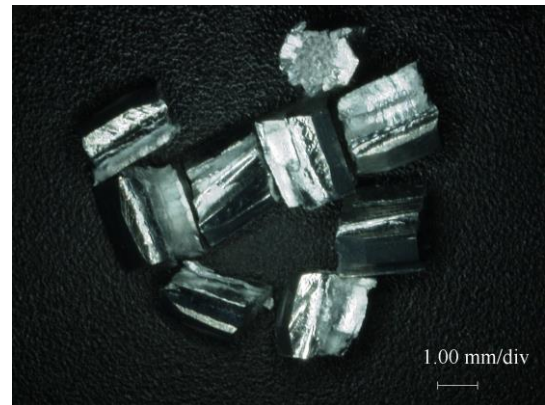
図4 異物（抜きカス）を模擬した A5052 切片
