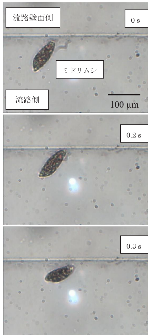
図8 CYTOPバイオチップ内の流体構造壁面顕微画像
