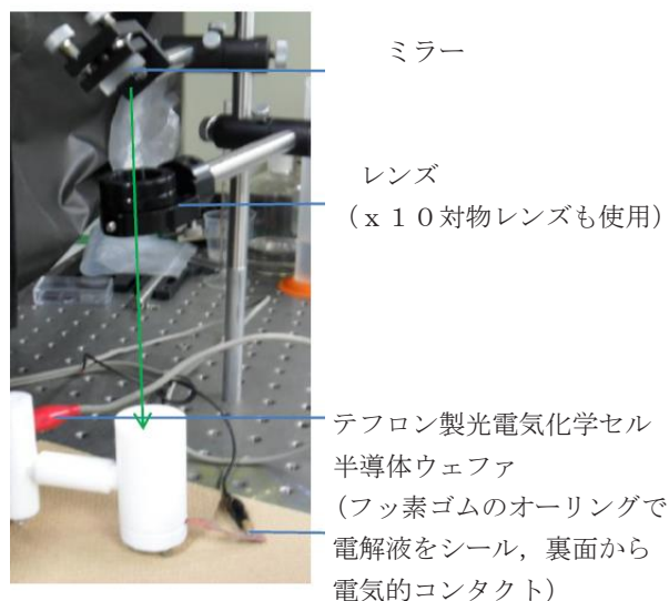
図 1 : 光電気化学セル (条件探索用)
