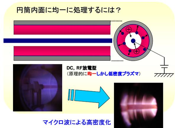
図 2 電圧印加型グロー放電による円筒面の均一処理法
