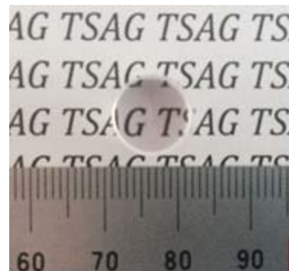
図6 高性能なファラデー素子への応用が期待されるTSAG結晶
