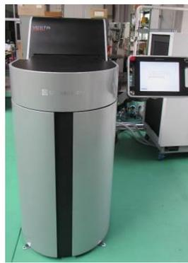
図4 真空脱脂焼結炉
