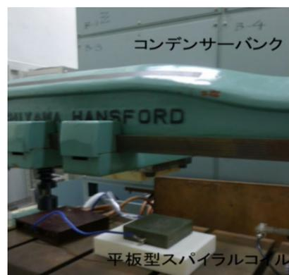
図 1 電磁成形装置の外観
