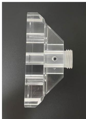
図 4 高速変形挙動の in-situ 観察実験で用いたアクリル製水圧室
