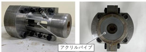
図 2 衝撃圧力波の可視化実験で用いた水圧室
