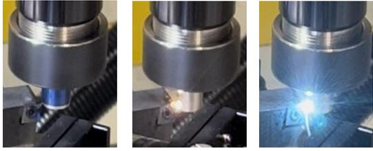
(a) 汎用旋削 (b) レーザ (c) レーザ(高出力)
