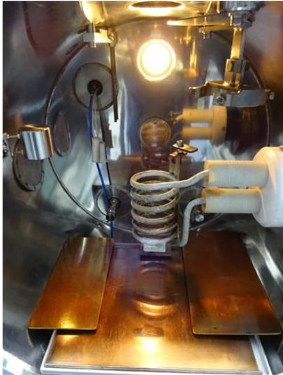
図2 高周波溶解装置内部
