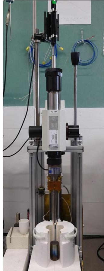
図3 半溶融鍛造装置外観写真
