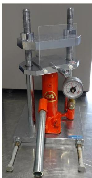
図5 油圧プレス装置外観写真
