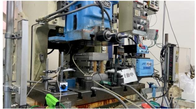
図 3 連続打抜き試験用装置外観
