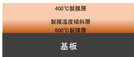
図 8 積層コーティングの概念図
