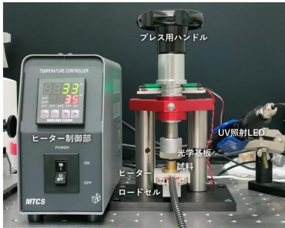
図1 薄ディスク利得媒質モジュール接合装置
