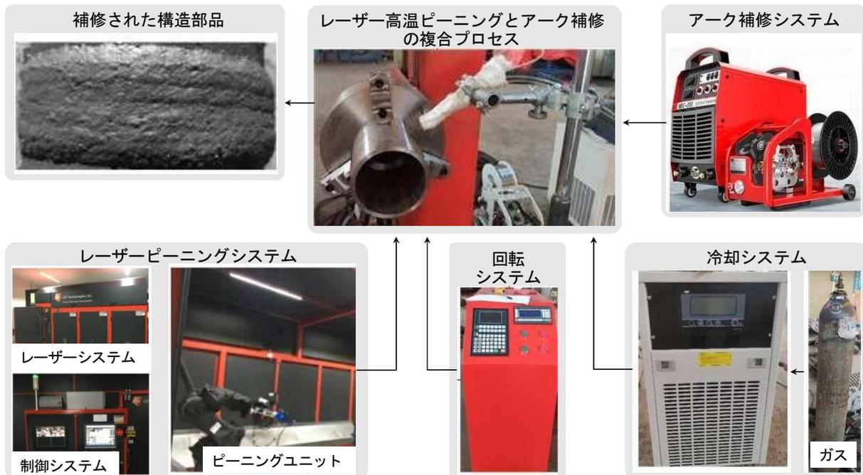
図1 レーザー高温ピーニングとアーク補修の複合プロセスの装置
